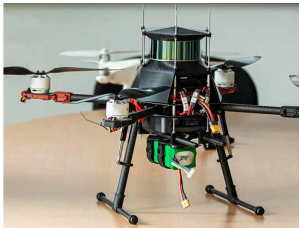
Bild 2: Ein UAS (Quadcopter) mit Sensoren zur Umgebungserkennung und Bewegungsmessung, das sich potenziell für die automatisierte Ist-Aufnahme eignen könnte.
